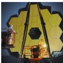
Il team del James Webb Space Telescope (JWST) della Nasa ha recentemente annunciato che è terminato con successo il posizionamento dei 18 tasselli, ciascuno a forma di esagono regolare, che compongono lo specchio primario da 6.60 m di “diametro” del telescopio (disegno a sinistra in basso: ognuna delle linee tratteggiate ha una lunghezza di 6.60 m). Nello specchio primario del JWST non è presente il tassello esagonale centrale, in quanto sarebbe oscurato dallo specchio secondario.
