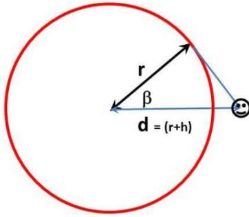
Con riferimento alla figura a sinistra, l'angolo  $\beta$  rappresenta il limite di visibilità di un corpo esteso per un osservatore posto a una distanza dello stesso ordine di grandezza delle dimensioni del corpo. Dalla ISS sarà quindi possibile osservare in totale, in ogni istante, un arco di meridiano  $A$  che sottende un angolo  $2\beta$ ; dal testo del problema, sappiamo che  $2\beta = 40^\circ.12$ .
