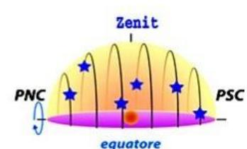
Sommando  $h_{\max}$  e  $h_{\min}$  di una stella che culmina a nord dello zenith, si ricava la latitudine dell'osservatore:
